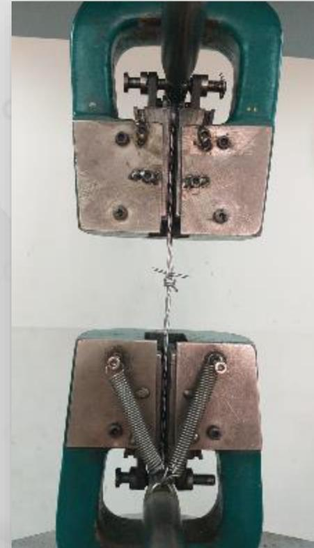
**ensayo de tracción**
