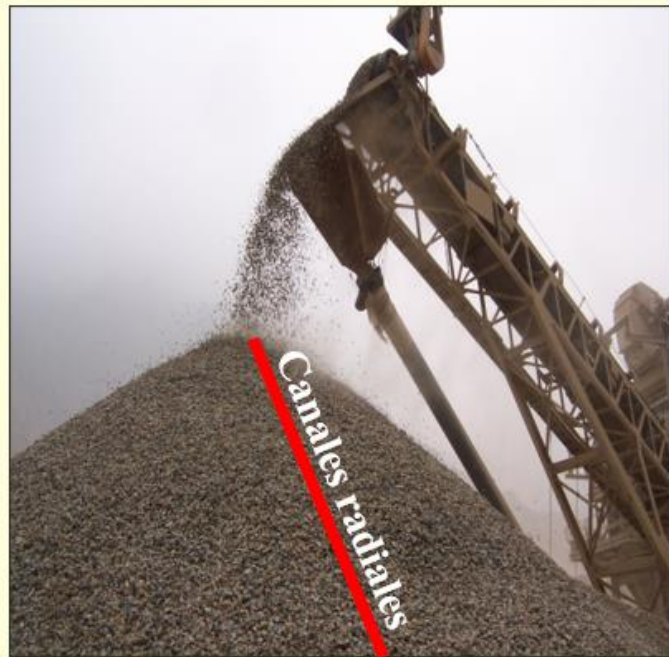
Muestra de pila Muestreo por canales. Aprox. 45 kg
