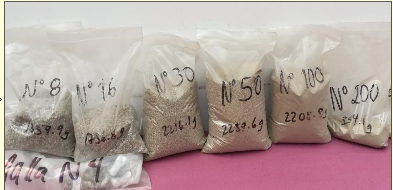
A laboratorio de petrografía: 16 a 10 kg para huso 4 a 5 10 a 5 kg para huso 67 5 a 1 kg de agregado fino Separado en fracciones granulométricas.
