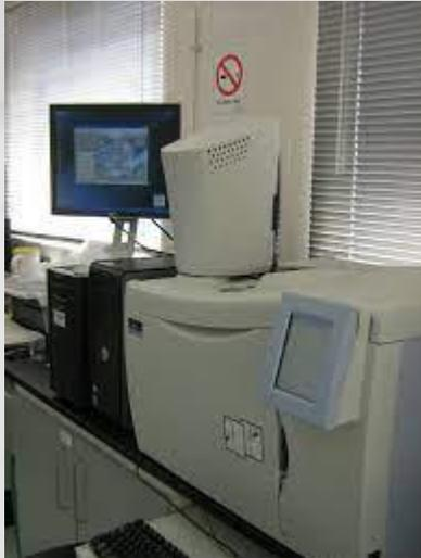
Cromatógrafo de gases con detector de Ionización de llama (FID)
