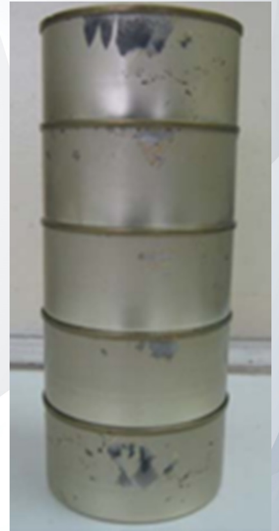
Envases con fallas de barniz
