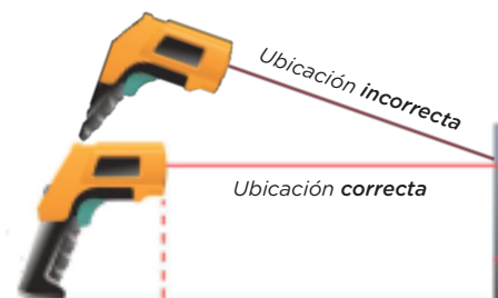
Figura 10. Las mediciones se deben hacer respetando la perpendicularidad.
