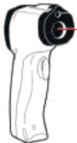
Figura 14. Ubicación de la lente en un termómetro infrarrojo.
