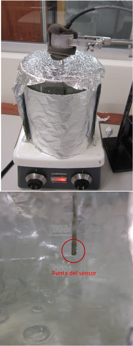
Figura 3. Medición en el punto de vapor del agua
