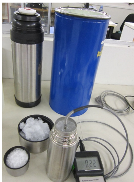
Figura 2. Punto de fusión del hielo (diversos contenedores con aislamientos térmicos)
