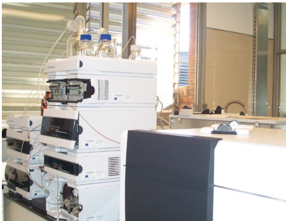
La automatización del espectrómetro de masa permite que el equipo trabaje en forma continua sin la intermediación de una persona. Foto: Valentina Guarinoni
