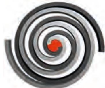
El compresor *inverter* está compuesto de dos espirales. Uno de ellos se mantiene estático, mientras que el segundo gira en forma concéntrica llevando el gas hasta la parte central donde es comprimido. El gas entra frío (figura 1) y es llevado al centro (figura 5) hasta calentarlo. El compresor *inverter* logra un ahorro de energía debido a que está constantemente en funcionamiento; únicamente varía su velocidad dependiendo de la temperatura de la habitación o espacio que se desee acondicionar.
