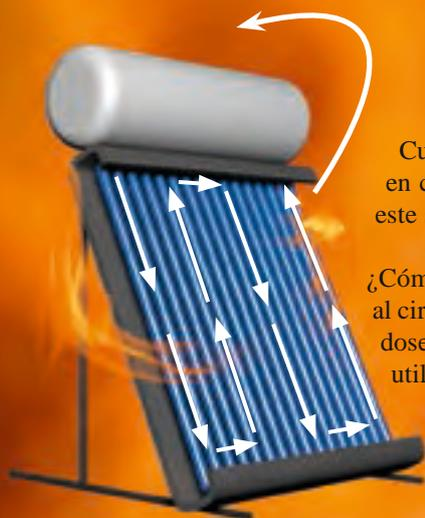
Cuando hablamos de la transformación de la radiación solar en calor, nos referimos a energía solar térmica. Por lo general este sistema es utilizado para el calentamiento de agua.
