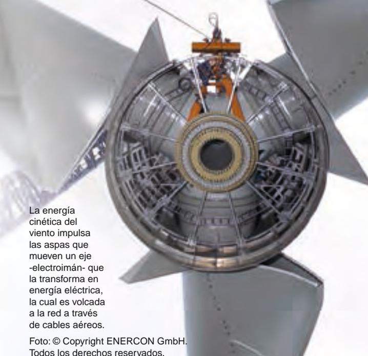
La energía cinética del viento impulsa las aspas que mueven un eje -electroimán- que la transforma en energía eléctrica, la cual es volcada a la red a través de cables aéreos.
