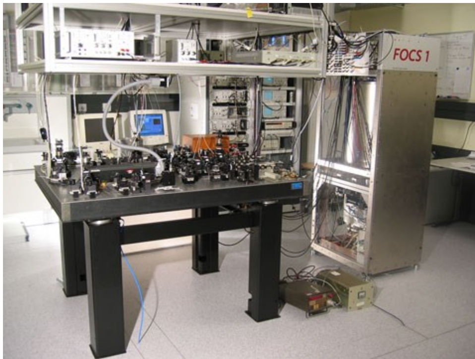
Fig. 1: El reloj atómico FOCS 1 de fuente de cesio frío continuo en Suiza que comenzó a funcionar en 2004 con una incertidumbre de un segundo en 30 millones de años.
