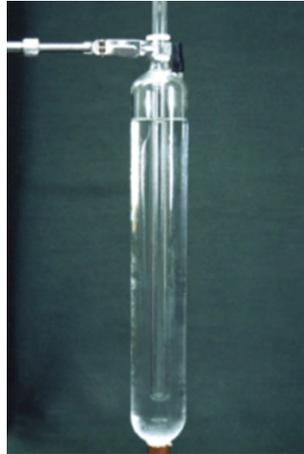
Fig. 1 Celda del Punto Triple del Agua
