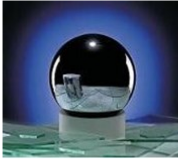
Fig. 3 Esfera de ^{28}\text{Si} , se observa la esfericidad y la superficie perfecta de la esfera. Foto del PTB
