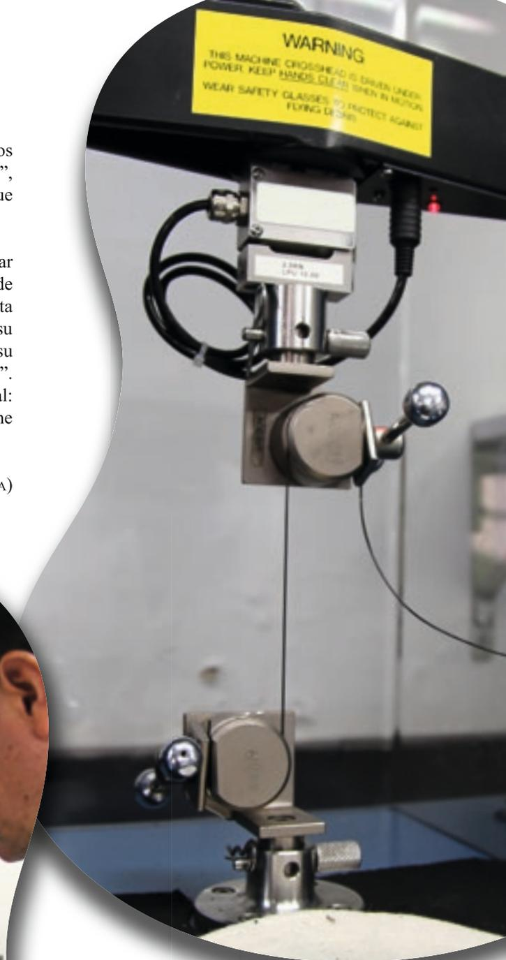
La calidad del sonido depende, entre otras cosas, de la calidad de las cuerdas de la guitarra; por esto se hacen pruebas en el equipo de ensayo de materiales, midiendo la resistencia de las mismas. También se mide el espesor de la cuerda, por interferometría óptica.
