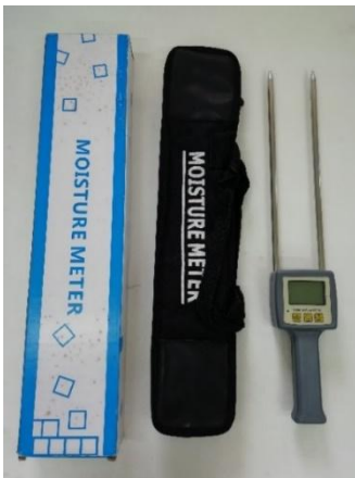
Figura 1. Medidor portátil de contenido de humedad en granos basado en el principio de resistencia eléctrica, con compensación automática de temperatura.
