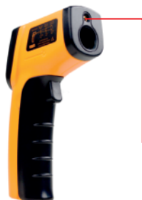
Figura 14. Ubicación de la lente en un termómetro infrarrojo.
