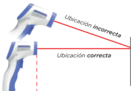
Figura 10. Las mediciones se deben hacer respetando la perpendicularidad.
