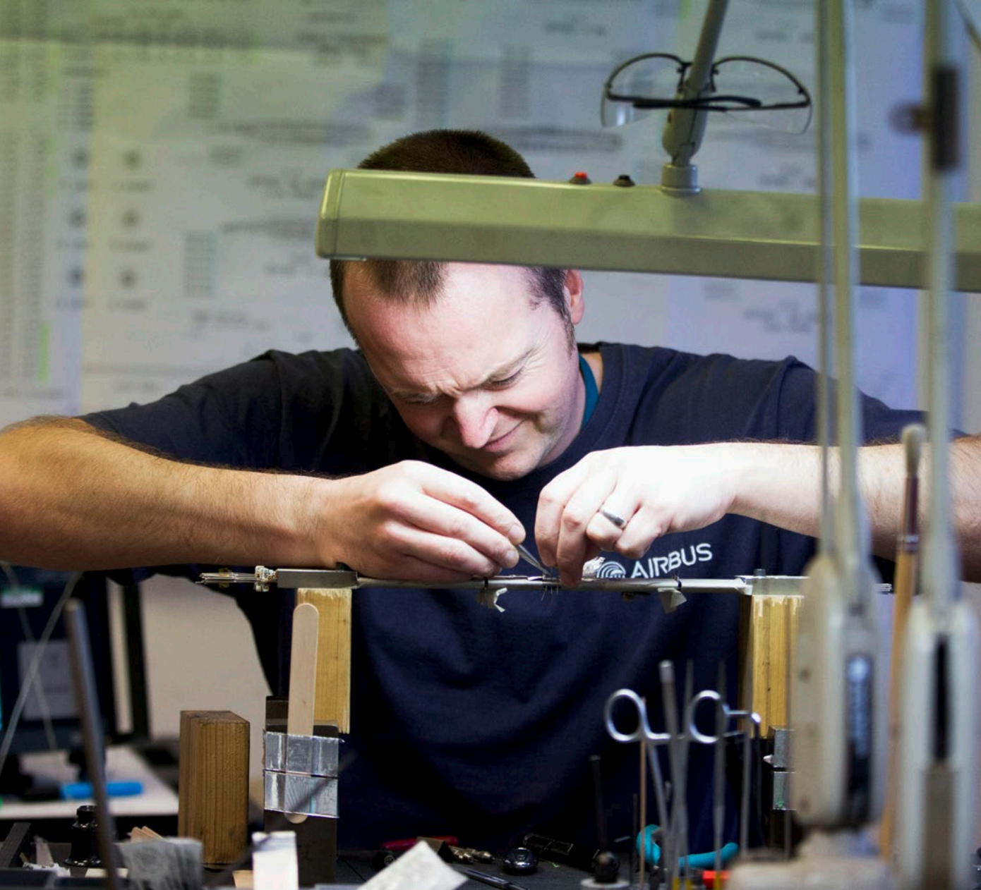
Preparativos de un modelo a escala para evaluarlo en la planta del fabricante aeronáutico Airbus en Filton, Bristol, Reino Unido.
