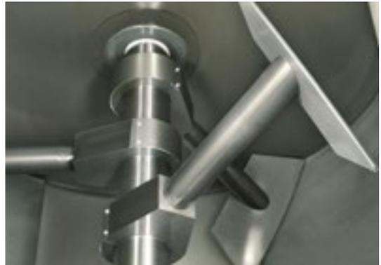
**Figura 57:** Equipos con riesgo de contacto metal-metal
