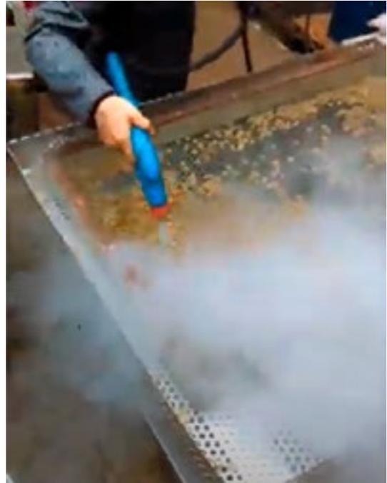
**Figura 37:** Uso de vapor en la limpieza de superficies en contacto directo con el producto
