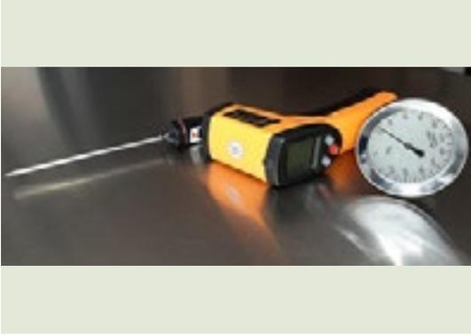
**Figura 59:** Termómetros con punta de acero y termómetro láser
