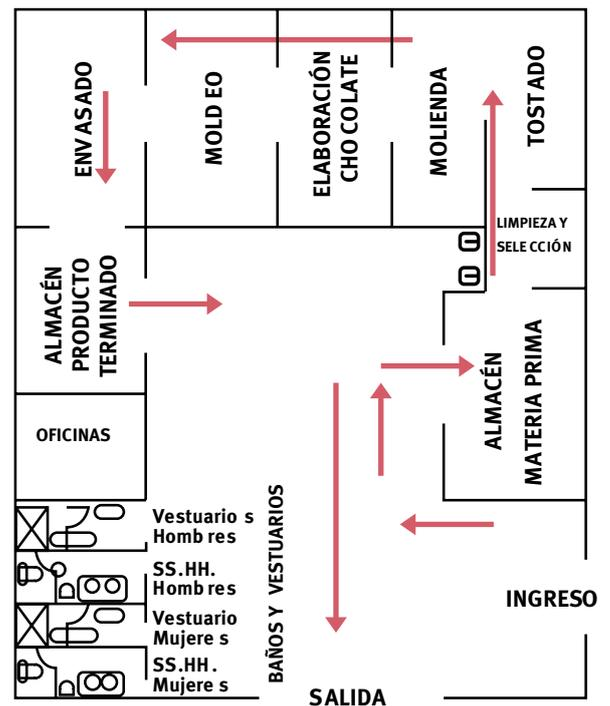
**Figura 24:** Ejemplo de flujo de un proceso productivo
