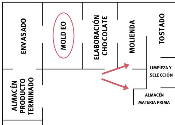
\*En el ejemplo de la Figura 21, se puede observar que el almacén de materia prima y el área de limpieza y selección de grano están separadas físicamente del área de moldeo.
