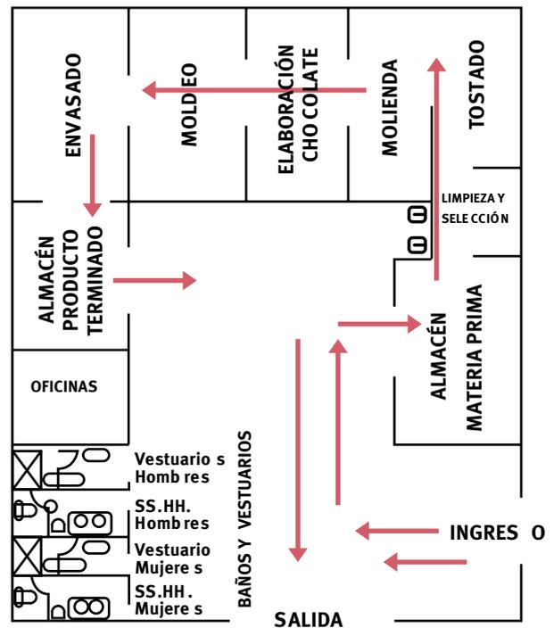
Figura 20: Ejemplo de diseño y distribución de planta
