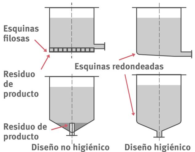
**Figura 29:** Diseño higiénico y no higiénico de tanques
