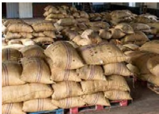
Figura 14: Almacenamiento de cacao en sacos de yute con distanciamientos adecuados para una correcta ventilación
