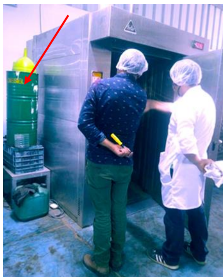
Figura 61 - Peligro químico por presencia de combustible en sala de procesos
