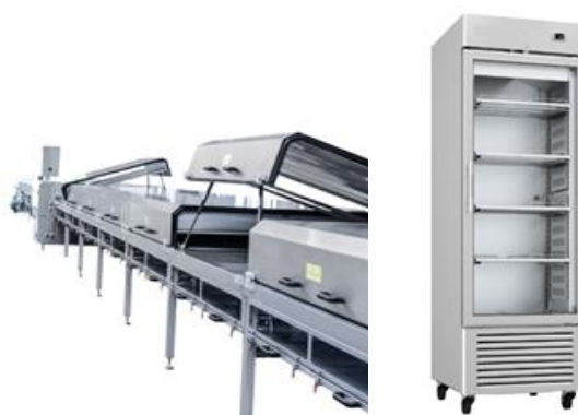
Figura 28 – Ejemplos de túneles o cámaras de enfriamiento con puerta de acceso y ventanas de inspección
