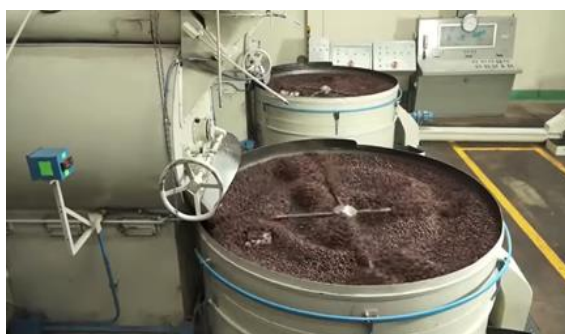
Figura 32 - Tostadora que trabaja a temperatura controlada
