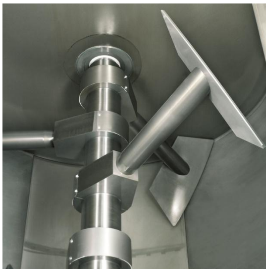
Figura 57 - Equipos con riesgo de contacto metal-metal
