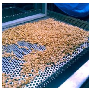
Figura 55 - Equipo de vibración para separar piedras e impurezas
