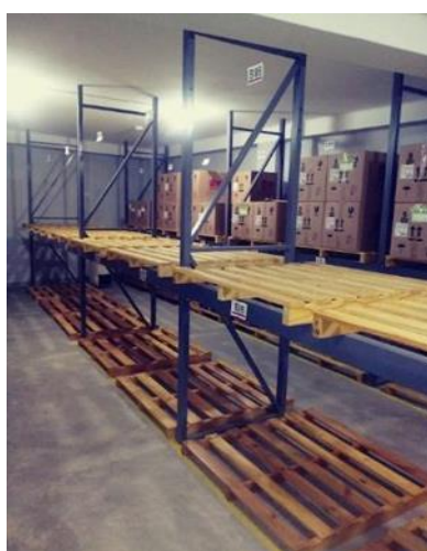
Figura 63 - Almacenamiento en racks sobre tarimas de madera
