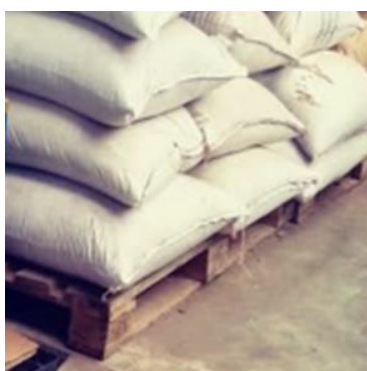
Figura 60 - Tarima de madera puede ser fuente de contaminación por astillas
