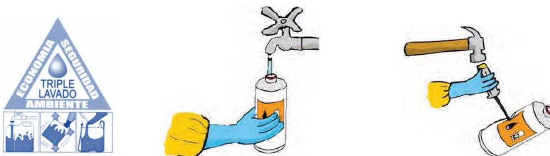
Figura 27 - Los envase después del triple lavado se deben destruir
