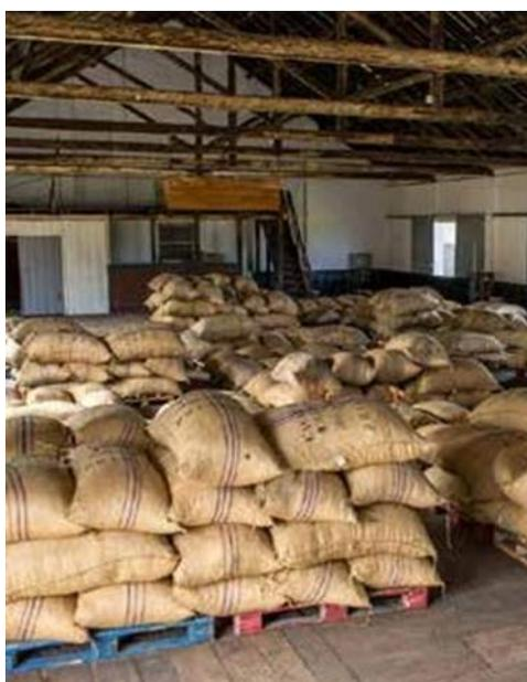
**Figura 14 – Almacenamiento de cacao en sacos de yute con distanciamientos adecuados para una correcta ventilación**
