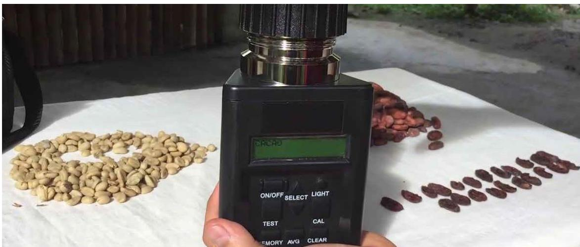
**Figura 4 – Ejemplo de medidor de humedad de granos de cacao**
