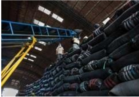
Figura 16 - Distancia mínima de 2 m de la última fila de sacos y el techo
