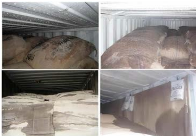
Figura 34- Manchas en los sacos por efecto de la condensación, durante el transporte marítimo
