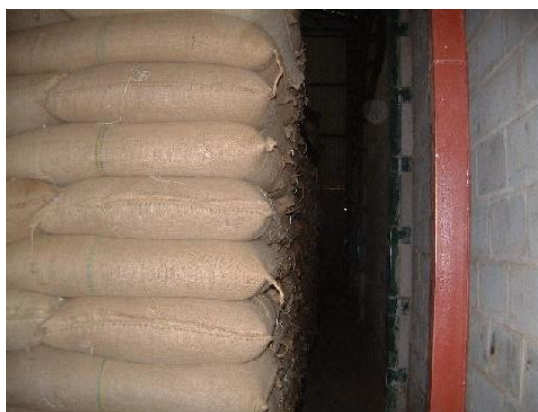
Figura 18 - Distancia sacos a pared debe ser más de 0,8 m
