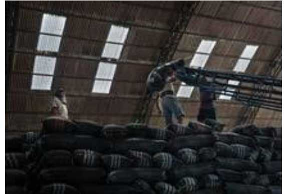
Figura 16 - Distancia mínima de 2 m de la última fila de sacos y el techo
