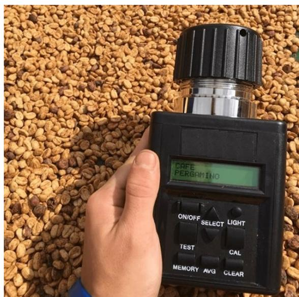
**Figura 1 - Ejemplo de medidor de humedad**
