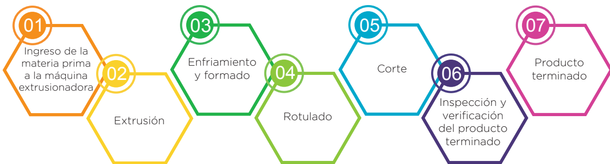
Figura 5. Proceso de producción de tuberías por extrusión
